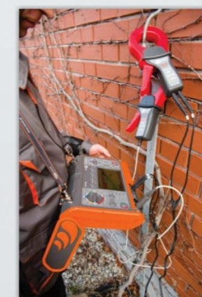
اندازه گیری مقاومت سیستم زمین و مقاومت لوپ ارت ( R_{loop} ) به کمک دو کلمپ (3P+)
