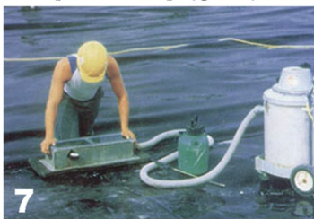
7 تست جوش دستی با دستگاه وکیوم
