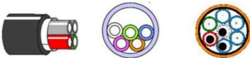
شکل ۷-۱۴: تقسیم فرعی کانال شکل ۷-۱۳: میکرو کانال پس از شکل ۷-۱۲: میکرو کانال حفاظت فرعی نصب شده
