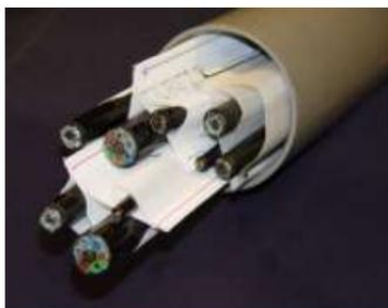
شکل ۷-۶: کانال اصلی ۱۱۰ میلی متری با ۹ کانال فرعی انعطاف پذیر
