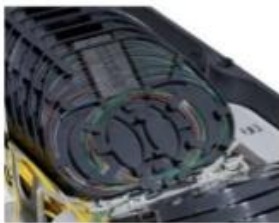
شکل ۶-۱۱: نمونه سینی های به هم تابیدگی پشته شده با مدیریت فیبر تکی
