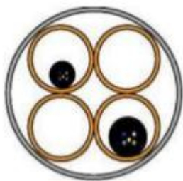
شکل ۷-۵: کانال اصلی ۱۱۰ میلی متری با چهار کانال فرعی سفت
