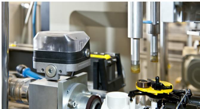
Le contrôle de la dépression permet de s'assurer que les composants sont correctement placés lors du montage entièrement automatisé des compteurs de gaz.
