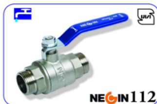
Model: NEGIN 112 مدل: نگین ۱۱۲ Size: G1/2" سایز: ۱/۲ اینچ PN: 25 Bar فشار کاری استاندارد: ۲۵ بار DN: 15 اندازه اسمی: ۱۵ Material: Brass جنس: برنج (روکش نیکل) Used: Non Gas مورد استفاده: غیر گازی
