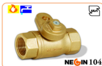
Model: NEGIN 104 مدل: نگین ۱۰۴ Size: 1" & 1 1/2" & 2" سایز: ۱" و ۱ ۱/۲" و ۲ اینچ PN: 5 Bar فشار کاری استاندارد: ۵ بار DN: 25 & 40 & 50 اندازه اسمی: ۲۵ و ۴۰ و ۵۰ Material: Brass جنس: برنج MS 58 Used: Gas مورد استفاده: گازی
