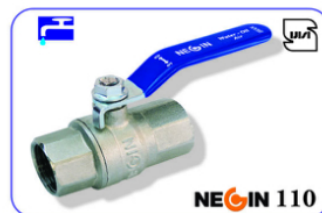
Model: NEGIN 110 مدل: نگین ۱۱۰ Size: G1/2".....3" سایز: ۱/۲ اینچ.....۳ اینچ PN: 25 Bar فشار کاری استاندارد: ۲۵ بار DN: 15 ..... 50 اندازه اسمی: ۱۵.....۵۰ Material: Brass جنس: برنج (روکش نیکل) Used: Non Gas مورد استفاده: غیر گازی
