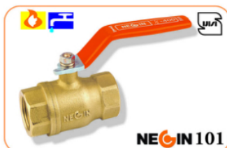
Model: NEGIN 101 مدل: نگین ۱۰۱ Size: 1/2".....3" سایز: ۱/۲".....۳ اینچ PN: 5 Bar فشار کاری استاندارد: ۵ بار DN: 15.....80 اندازه اسمی: ۱۵.....۸۰ Material: Brass جنس: برنج MS 58 Used: Gas مورد استفاده: گازی
