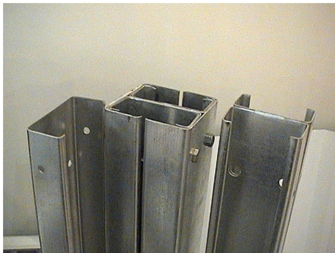
شکل ۵. مقاطع فولادی مورد استفاده برای ستون با استفاده از پروفیل‌های سرد نوردشده
