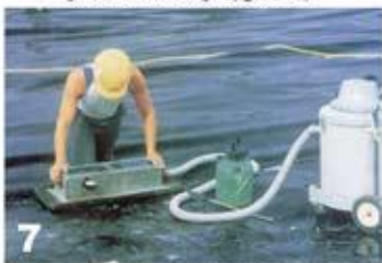
تست چوش دستی با دستگاه وکیوم
