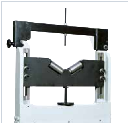
Equipaggi a V con rulli per l'equilibratura di alberi completi di cuscinetti. V carriage with rollers for balancing rotors with their own bearings.
