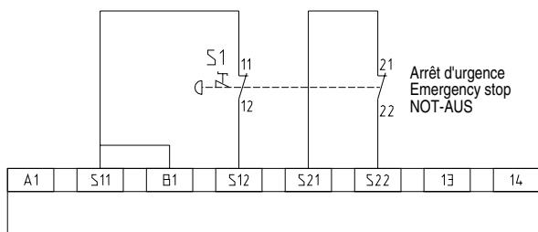
Raccordement de plusieurs boutons arrêt d'urgence
