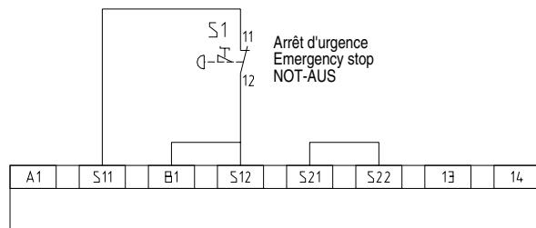
Raccordement du bouton à deux voies, sans détection des courts-circuits
