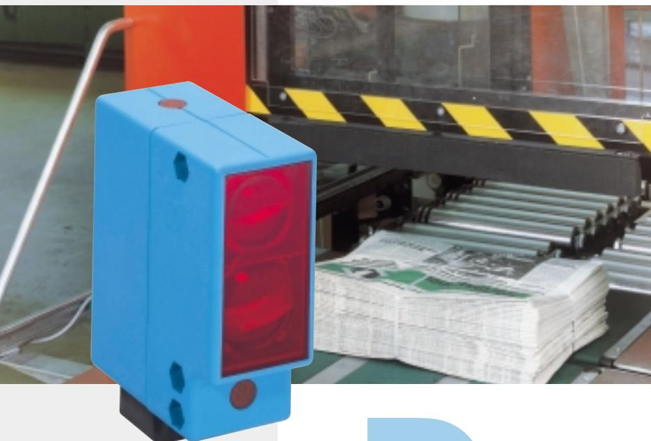
Les exigences envers la résistance des capteurs sont souvent élevées. Un indice de protection adapté IP 65 ou IP 67 selon le type de raccordement, des boîtiers en plastique solides, le contrôle et le témoin d'encrassement ainsi que l'insensibilité aux lumières parasites garantissent une commutation sûre dans les environnements industriels difficiles.
