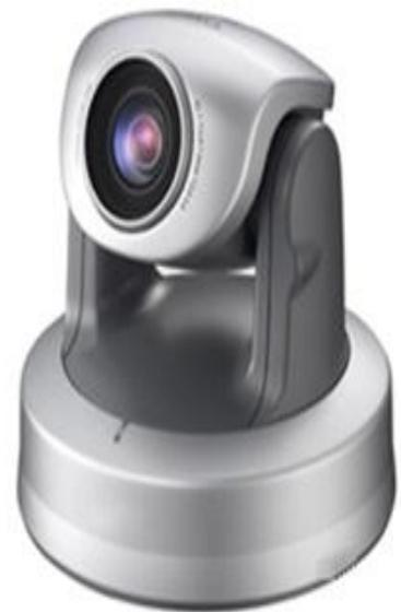
این دوربینها قابلیت حرکت افقی ، عمودی و همچنین زوم اپتیک و دیجیتال بصورت کنترل دستی و اتوماتیک دارند. در حالت کنترل دستی، یک دوربین PTZ می تواند به عنوان مثال در یک محیط فروشگاهی برای تعقیب یک فرد مورد استفاده قرار گیرد این دوربینها جهت دید مشخص دارند و فاقد امکان حرکت 360 درجه کامل هستند و برای حرکت اتوماتیک دائمی ساخته نشده اند. زوم اپتیک این دوربینها معمولا بین 18 تا 26 برابر است.
