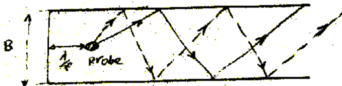
شکل (۴-۷) انتشار امواج در یک موجبر
