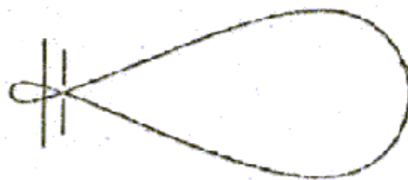
شکل (۱۳-۳) نمونه پرتو تشعشع برای آنتن نیم موج (دوقطبی) با فلکتور
