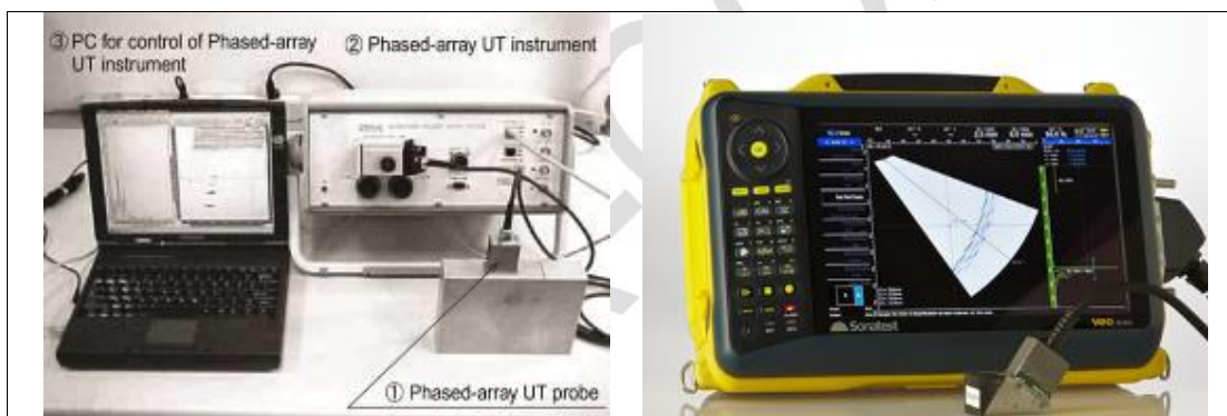
تصویر ۱ - دستگاه پرتابل ساخته شده با سیستم Phased Array (راست) و مقایسه آن با نمونه های اولیه (چپ)
