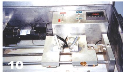
10 تست چسبندگی (Peel) جوش دستگاه اتوماتیک
