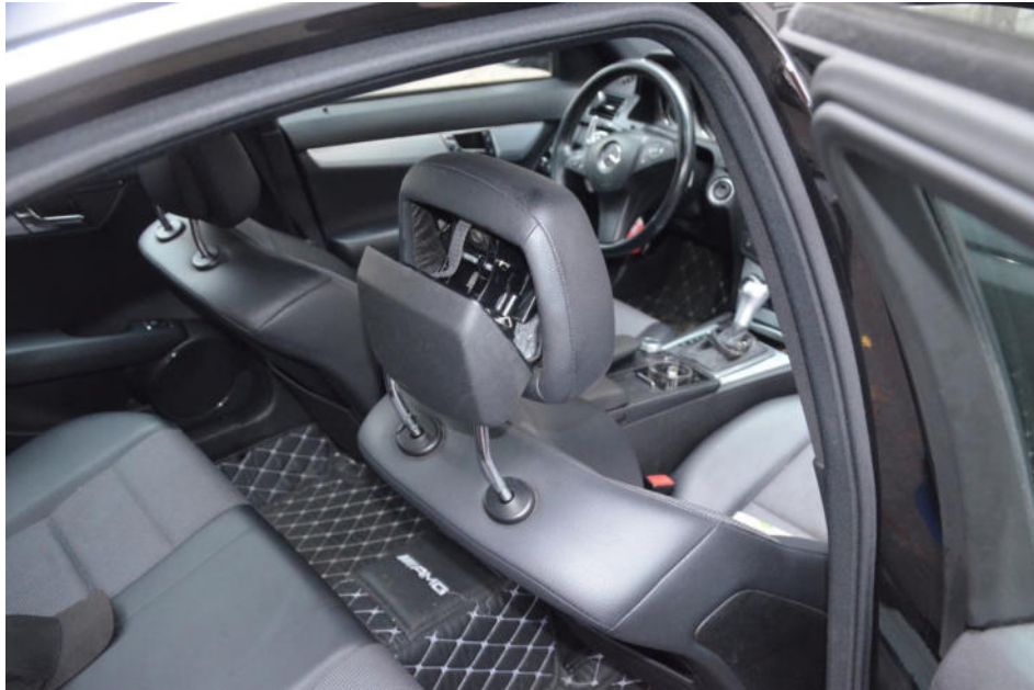
Bild 7 Schadenansicht Kopfstütze vorne rechts, Auslösung Neck-Pro
