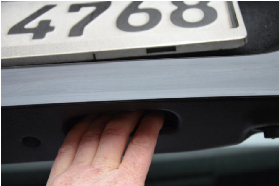
Bild 19 Schadenansicht Deckel hinten, anstoßbedingt Beschädigung der Lackierung
