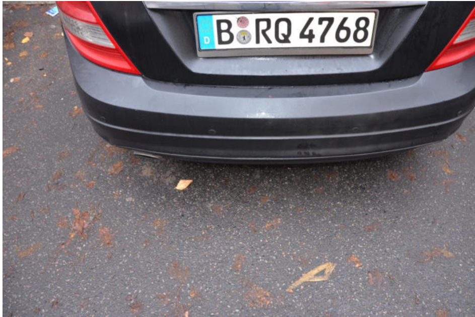
Bild 9 Schadenansicht Stoßfänger hinten, Verkratzungen und Verformung bzw. Überstreckung
