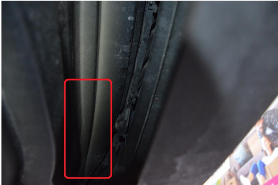
Bild 21 Schadenansicht Querträger Stoßfänger hinten, Verformung
