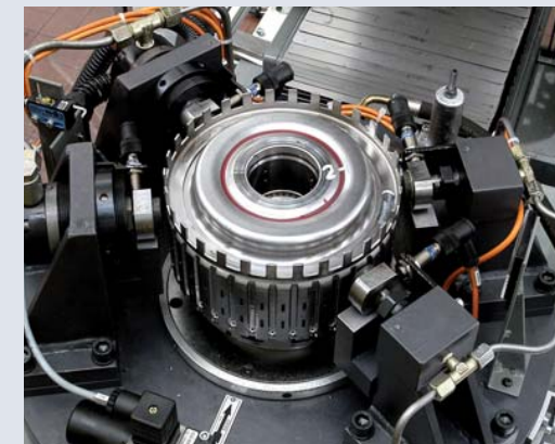
Macchina per equilibratura dei particolari del cambio automatico
