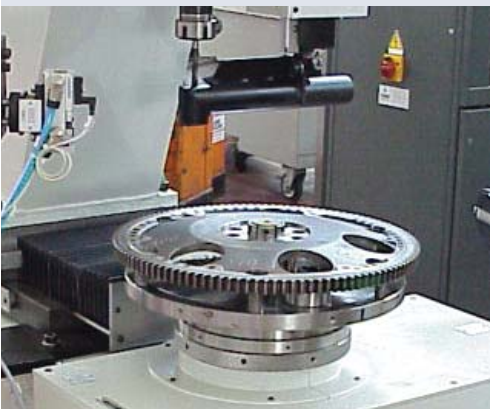
Macchina automatica per volani, con unità foratrice elettro-pneumatica e marcatore di posizione.
