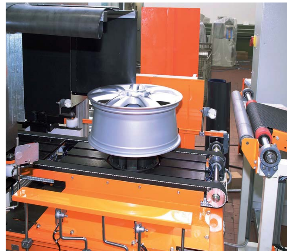
Impianto di equilibratura per controllo di cerchi in lega.
