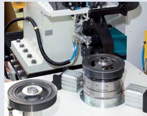
Equilibratrice automatica per pulegge con unità di foratura ad asse controllato.
