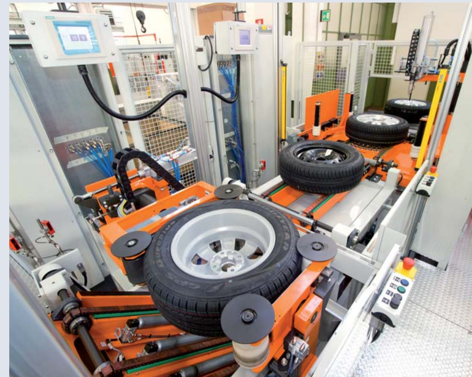
Impianto di equilibratura per ruote auto con stazione di correzione orizzontale.
