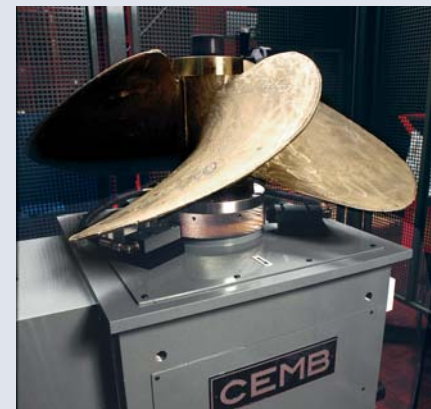
Macchina per equilibratura su due piani per rotori di elevate dimensioni.
