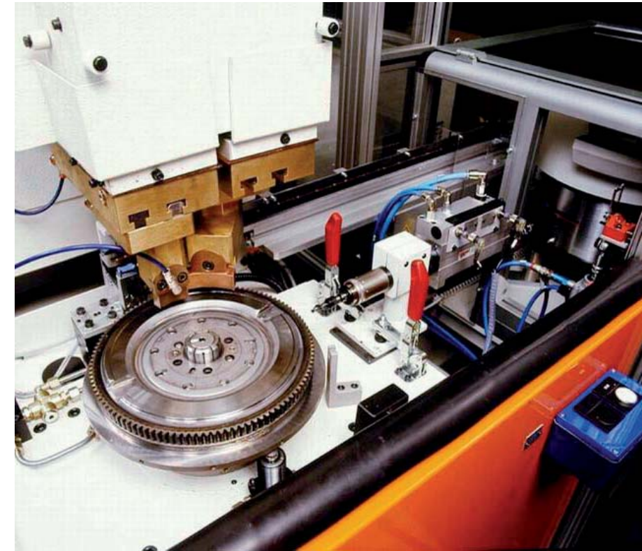
Equilibratrice con correzione automatica mediante saldatura di piastrelle.
