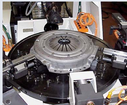
Equilibratrice automatica per frizioni con unità di foratura ad asse controllato.
