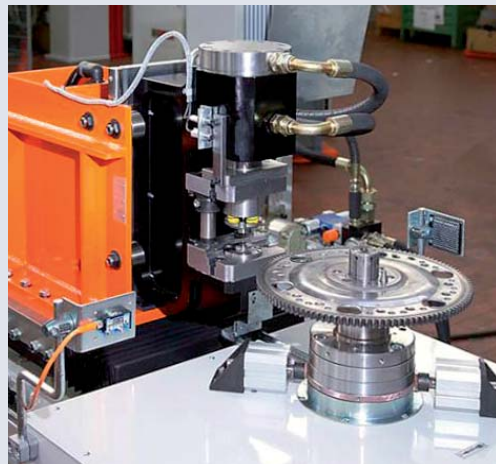
Macchina equilibratrice automatica per volani con unità di punzonatura idraulica.
