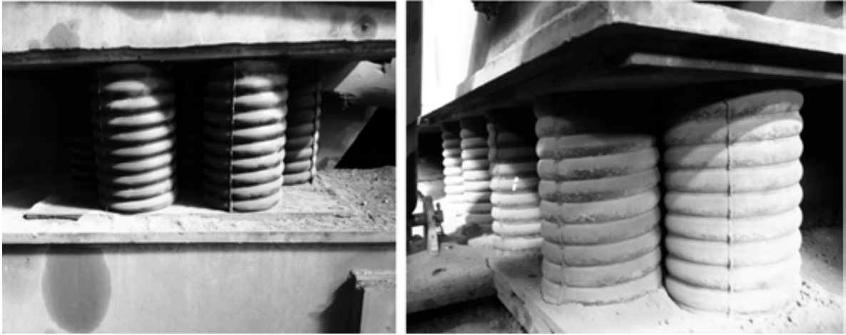
شکل ۱۰- فاصله بین لرزه‌گیرها کم و تعداد آنها زیاد است و نامتقارن نصب شده‌اند.
