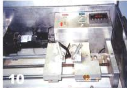
10 تست چسبندگی (Peel) جوش دستگاه اتوماتیک
