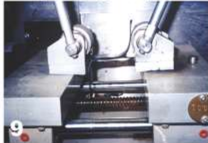
9 تست برشی (Shear) جوش دستگاه اتوماتیک
