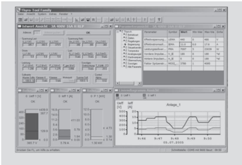
Leistungssteller der Thyro-A Reihe können mit Hilfe der PC-Software THYROTOOL FAMILY komfortabel bedient und eingestellt werden. Voraussetzung zum Arbeiten mit THYRO-TOOL FAMILY ist, dass die Verbindung zwischen PC und Leistungssteller vorhanden ist. Damit sind Messwert-Visualisierung und Parameteransicht möglich. Wird der Thyro-A nicht im Thyro-Tool Modus betrieben, sind einige Parameter änderbar. Im Thyro-Tool Modus sind Änderungen an fast allen Parametern möglich.
